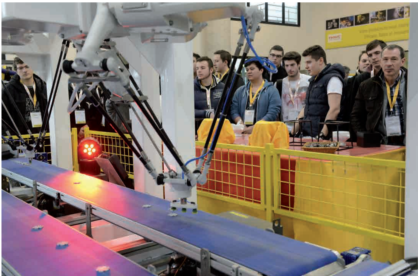
Le robot araignée est capable de repérer et saisir en même temps plusieurs pièces, en l'occurrence, ici des jetons de poker.
