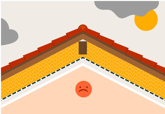
Étape 1 Isolation de la toiture par l'intérieur
