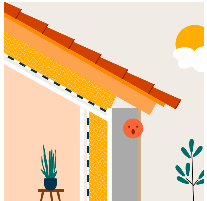
Étape 2 Isolation des murs par l'intérieur
