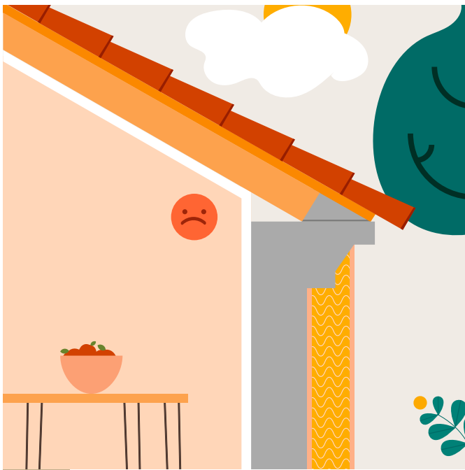
Étape 1 Isolation des murs par l'extérieur
