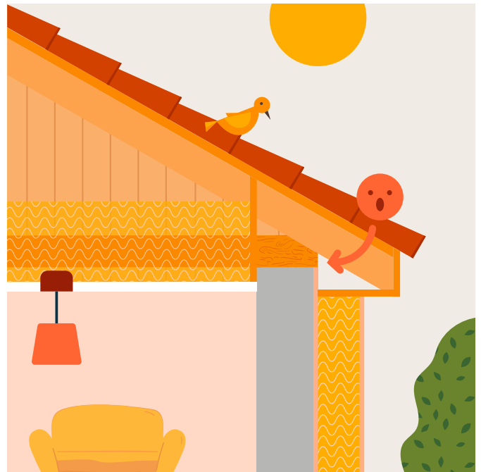
Étape 2 Isolation des combles perdus
