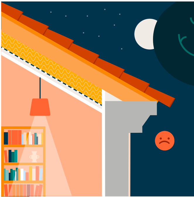
Étape 1 Isolation des rampants
