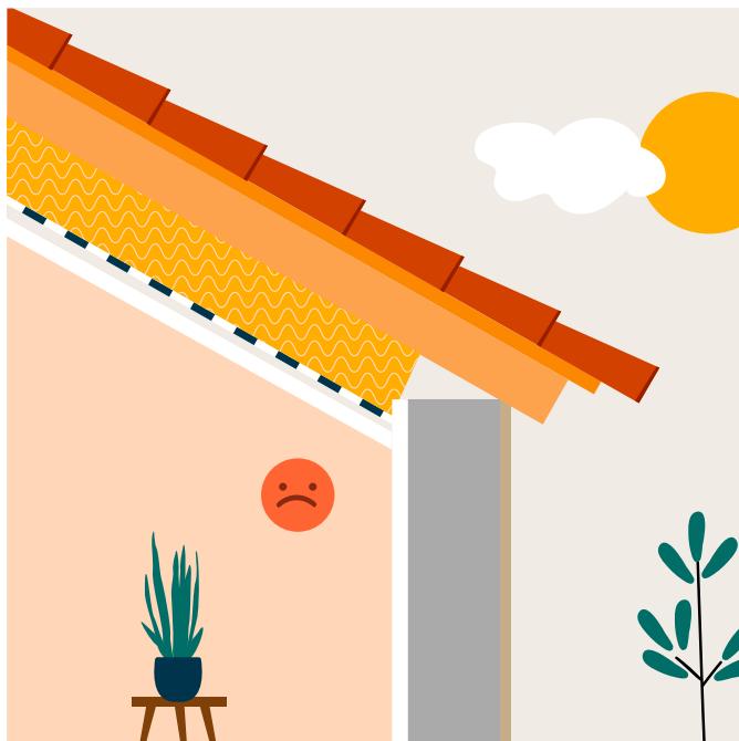
Étape 1 Isolation des rampants
