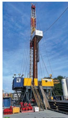
Les travaux de forage géothermique réalisés en 2021 (jusqu'à 1600 m de profondeur) vont permettre d'alimenter en chauffage et en eau chaude sanitaire l'équivalent de 8500 logements dont des bâtiments publics tels que les écoles et les hôpitaux. Grâce à cette source d'énergie, 11000 tonnes de CO<sub>2</sub> seront évitées par an.
